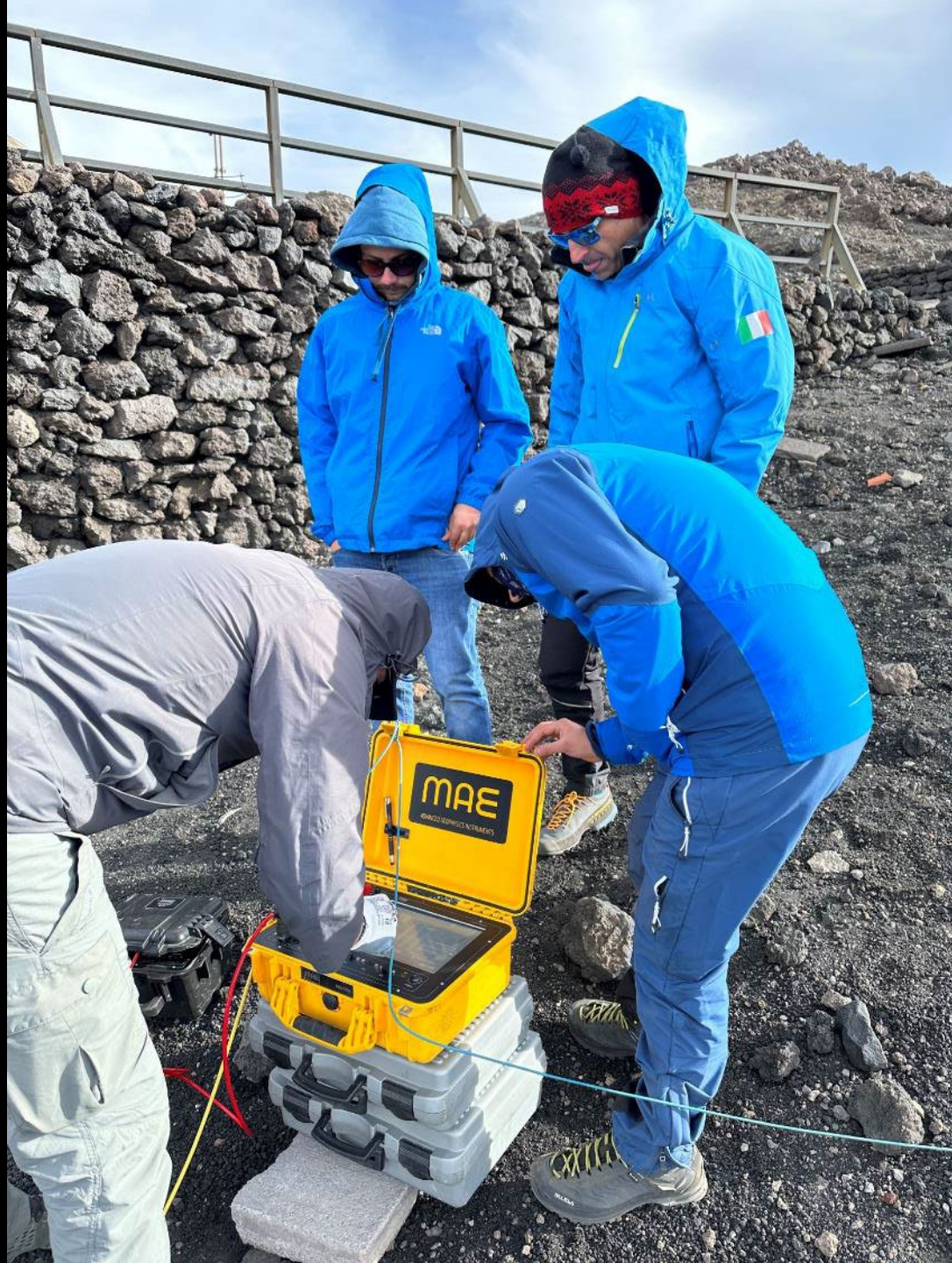
Attività di indagine MASW (multi channel analysis of surface waves) del team dello studio tecnico Carlo Cassaniti durante il sopralluogo di Novembre 2023 svolto con INGV
